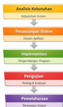
Gambar 1. Diagram Alur Metode Pengembangan Sistem Waterfall
