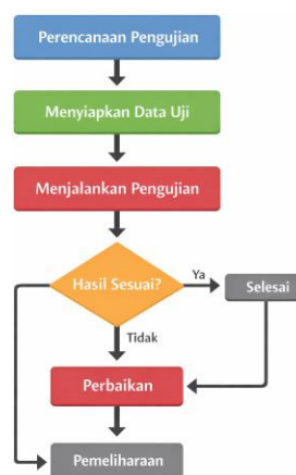
Gambar 3. Alur Pengujian Sistem Menggunakan Blackbox Testing
